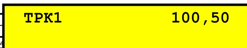
Нажать клавишу ВВОД. При наличии связи с ТРК на дисплей будет выдано сообщение «Correct given!», подтверждающее прием коррекции колонкой. На дисплеях ТРК высветится новое значение коррекции (в данном случае – 100,50). Нажать клавишу ВВОД.
